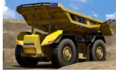
二輪だった駆動部を四輪にして、それぞれに米ゼネラル・エレクトリックと共同開発した小型モーターを取り付けた。四輪とも自在に動かせるようにして滑りやすい悪路の運行時でも安全性を高めた。
