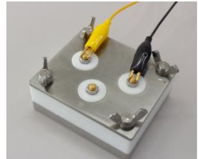
試験用マグネシウム蓄電池セル
