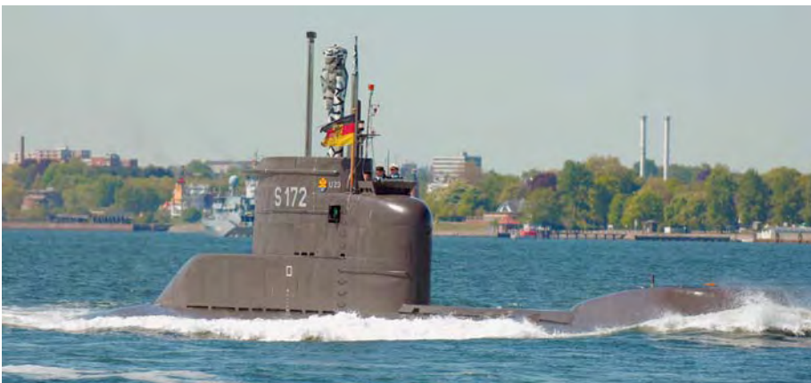
U23, ein Boot der Klasse 206A, das aus dem neuen Stahl 1.3964 hergestellt wurde (Foto: Kai Henrik Schütz)
